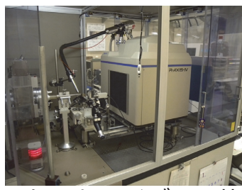
カスタマイズXRD装置 (斜入射(GI)測定・加熱冷却・光照射)
