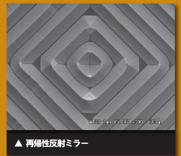
▲ Si基板上に形成したひずみ Ge/SiGe微細柱状構造のSEM像
