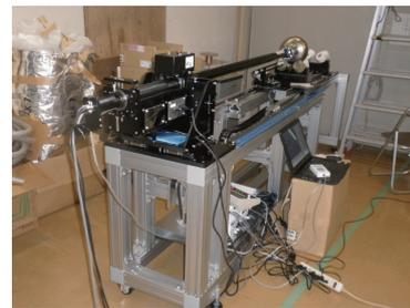
京大、KEKが開発し米国に販売された超伝導加速管検査装置
