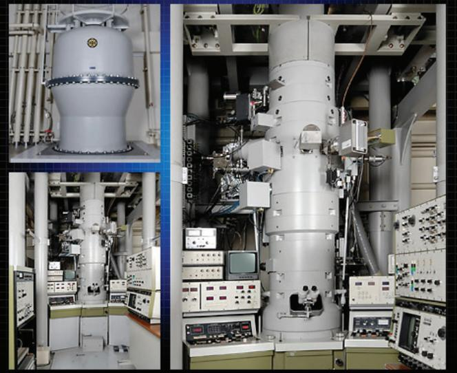
収差補正電子顕微鏡
