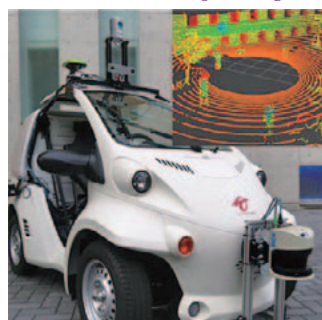
自動運転機能付き一人乗り EV Personalized Automated Electric Vehicle
