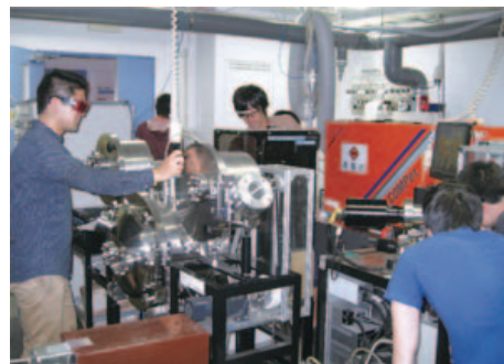
超伝導マグネットに向けた超伝導線作製装置 Fabrication system of superconducting coated conductors for superconducting magnets
