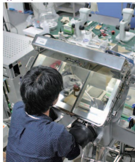
不活性雰囲気下での試料合成 Material synthesis under inert gas atmosphere
