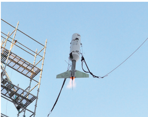
パルスデトネーションロケットの飛行実証試験 Flight Demonstration of a Pulse Detonation Rocket Engine
