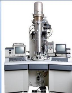
加速電圧200kV、電子線ホログラフィーにより、微小電位・微小磁場観察、磁場シールドレンズの組込により、直接倍率50万倍、モニター上で1500万倍まで拡大して磁性材料の磁化分布観察、ナノメートルオーダーでの内部電位分布の観察が可能。
