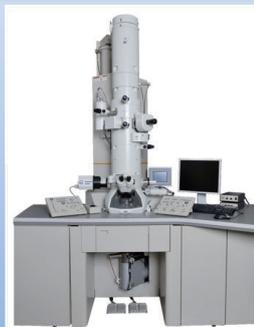
加速電圧200kV、EELS、波長分散X線分光（WDX）、カソードルミネッセンス（CL）が100Kから1000Kの温度範囲で可能
