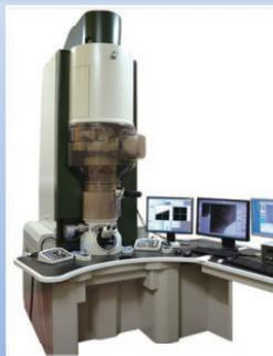
加速電圧200kV、集束レンズ系、結像レンズ系の両方に球面収差補正器を装備。点分解能0.10nm、エネルギー分散X線分析（EDX）、EELS、電子線ホログラフィーを用いた原子分解能での微小電位観察が可能
