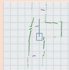
センサーが取得した周囲の壁(緑色の点)と移動障害物(ピンク色の点)までの距離
