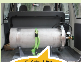
バイオメタン 充填タンク
