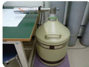
(ORTEC社製 GEM10P4-70) 分解能@662 keV 0.2%
