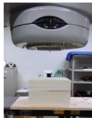
名古屋第二赤十字病院ライナック治療装置における特性評価試験
