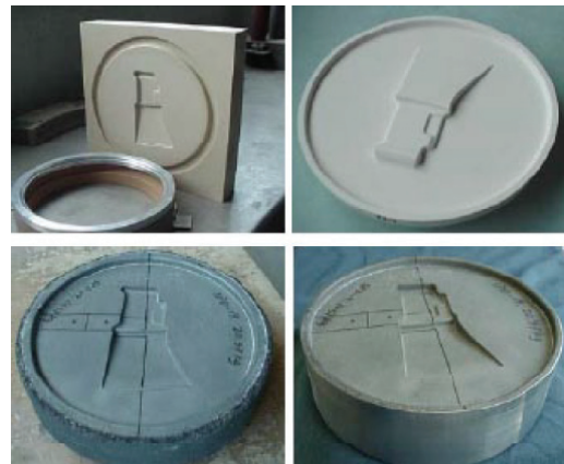
精密溶射成形 (PSF) 処理例
